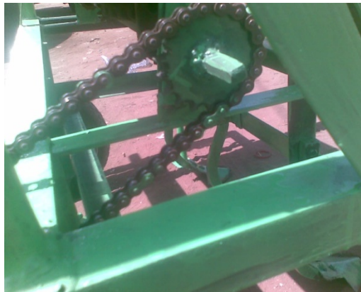
(d) Motion transmission chain
